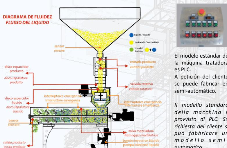
El modelo estándar de la máquina tratadora es PLC. A petición del cliente se puede fabricar en semi-automático.
